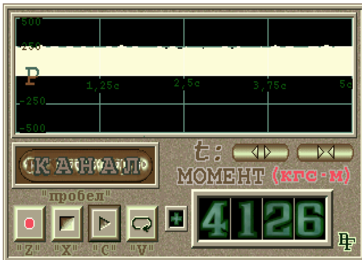
Рисунок 5.23 – Осциллограмма мощности двигателя привода с использованием противофазного способа компенсации релаксационных Колебаний
