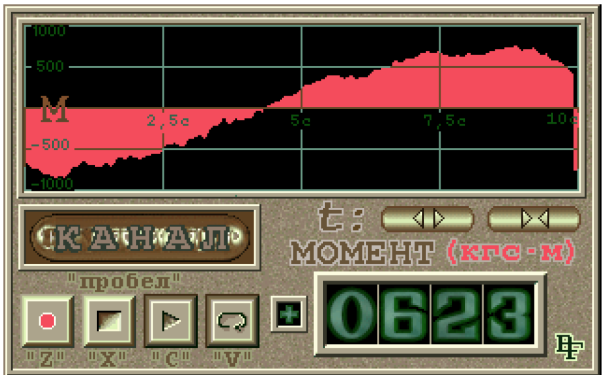
Рисунок 4.22 – Осциллограмма динамического наброса момента при осевой нагрузке 140кН (масштаб 1:1)
