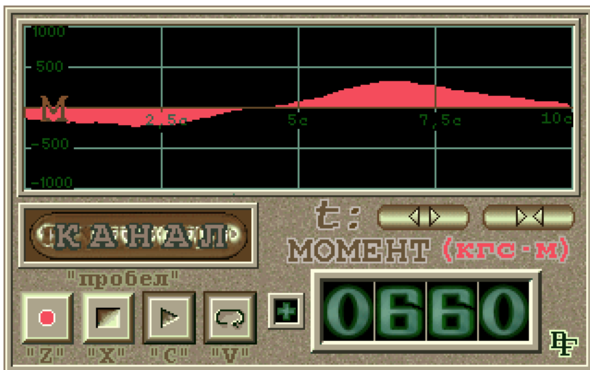
Рисунок 2.11 – Осциллограмма приращения крутящего момента при осевой нагрузке 120кН
