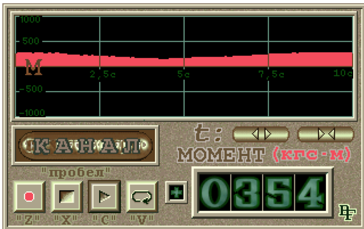
Рисунок 4.15 – Осциллограмма суммарного значения крутящего момента при осевой нагрузке 120 кН
