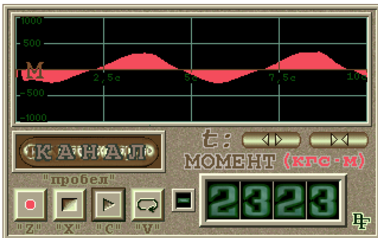
Рисунок 4.25 – Осциллограмма динамического наброса момента при осевой нагрузке 160кН (масштаб 1:10)
