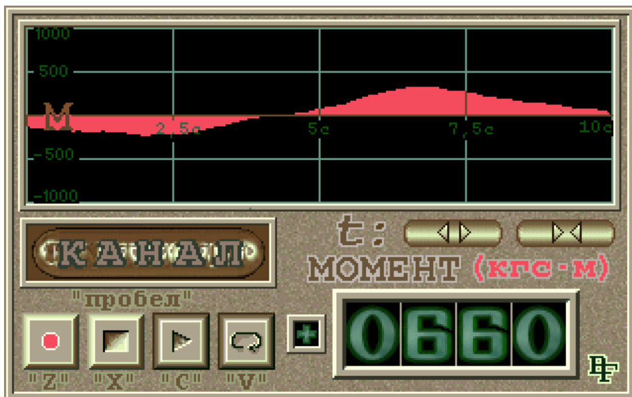
Рисунок 4.16 – Осциллограмма динамического приращения крутящего момента при осевой нагрузке 120 кН
