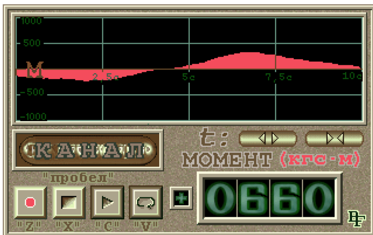
Рисунок 4.19 – Осциллограмма динамического наброса момента при осевой нагрузке 120кН (масштаб 1:10)
