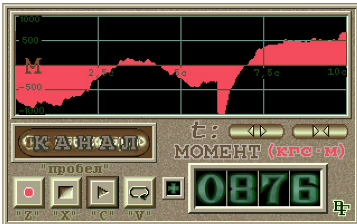
Рисунок 2.10 – Осциллограмма приращения крутящего момента при осевой нагрузке 120 кН
