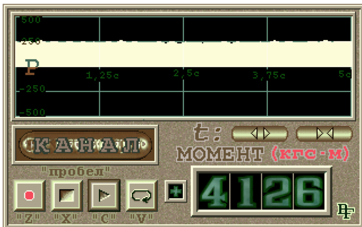
Рисунок 4.14 – Осциллограмма мощности двигателя привода при осевой нагрузке 120 кН
