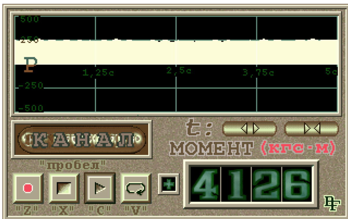
Рисунок 4.5 – Осциллограмма мощности при осевой нагрузке 160 кН с системой компенсации релаксационных колебаний
