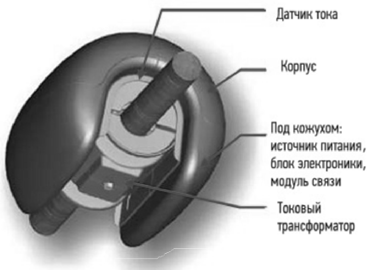
Рис. 41. Прибор OTLM-system для мониторинга токовой нагрузки ВЛ
