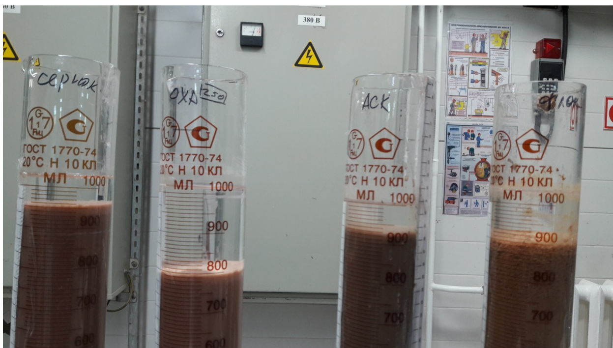
Рисунок 4.11 Результаты по осаждению сапонитовой пульпы, содержание твердого 25-30 г/л спустя 60 минут
