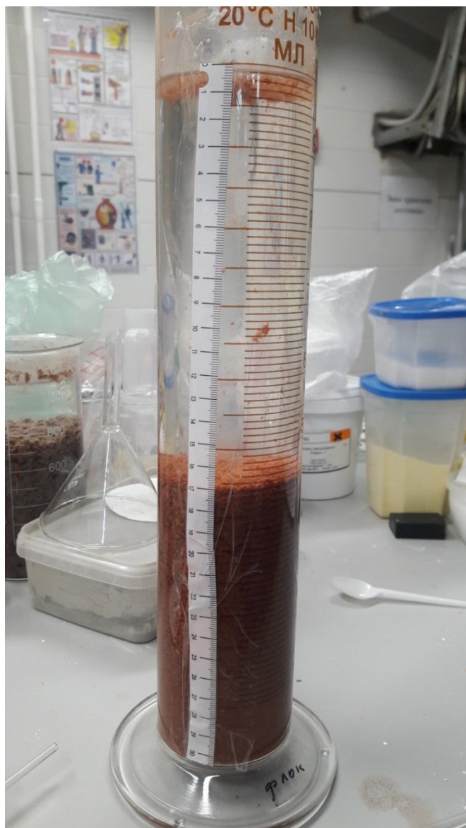
Рисунок 4.6. Дренажная вода с добавлением флокулянта
