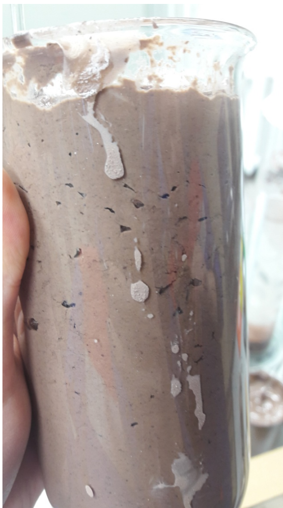
Рисунок 4.8. На фото представлен результат добавления 7 % раствора сернокислого алюминия в обратную воду с содержанием твёрдого 115 г/л, как видно на фото гидролиза коагулянта не происходит.
