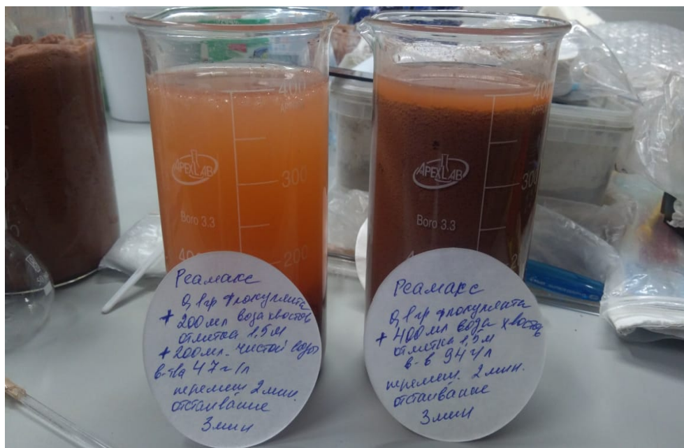
Рисунок 4.14 Обработка флокулянт Rheomax 9010, на фото видно, что без разбавления и без предварительной обработки хлорным железом и щёлочью процесс осаднения не идёт (стакан 2), после разбавления и без предварительной обработки пульпы процесс осаднения идёт, но недостаточно хорошо (стакан 1)
