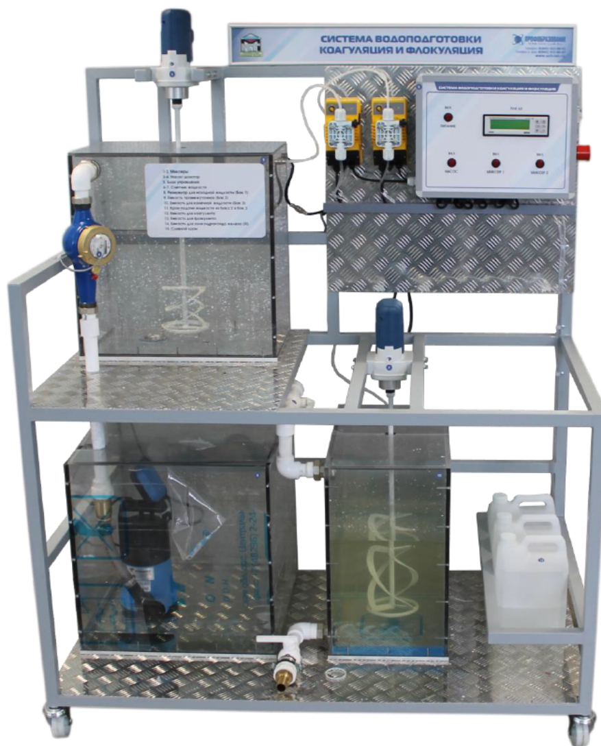
Рисунок 7.2. Общий вид полупромышленной установки системы водоподготовки коагуляция и флокуляция
