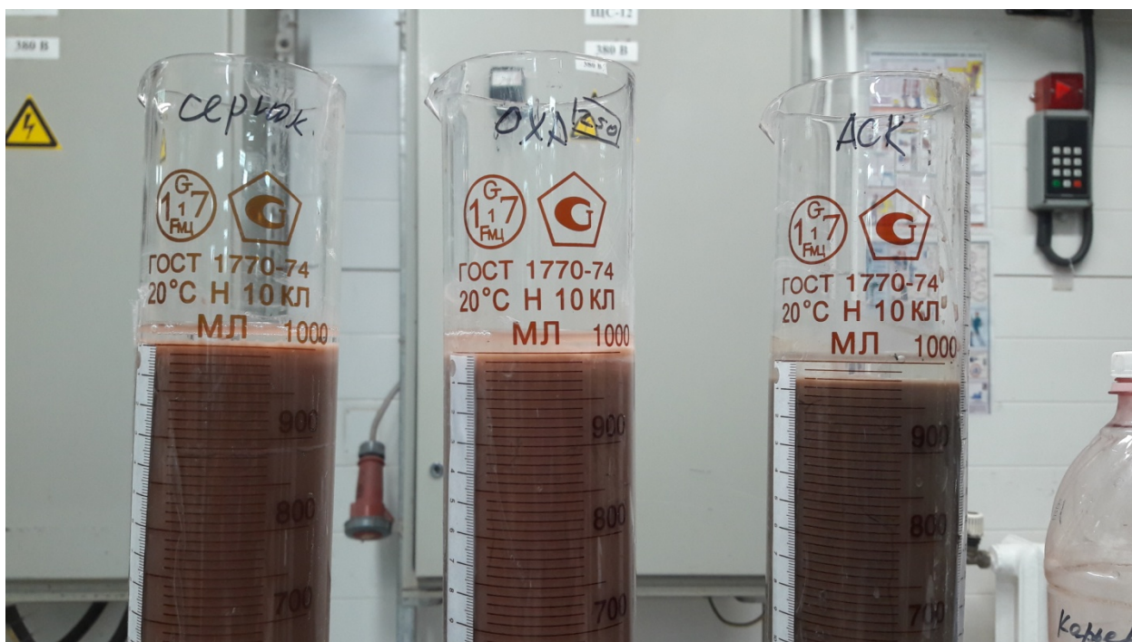
Рисунок 4.9. Разбавление пробы оборотной воды до 50-60 г/л – время отстаивания 30 минут: 1) 7 % раствор сернокислого алюминия; 2) 9% раствор оксихлорида алюминия + подщелачивание; 3) кальцийалюмосиликатный реагент
