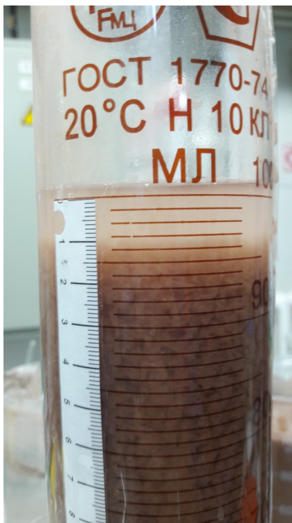
Рисунок 4.10 Разбавление пробы оборотной воды до 50-60 г/л с обработкой флокулянт, время отстаивания - 40 минут
