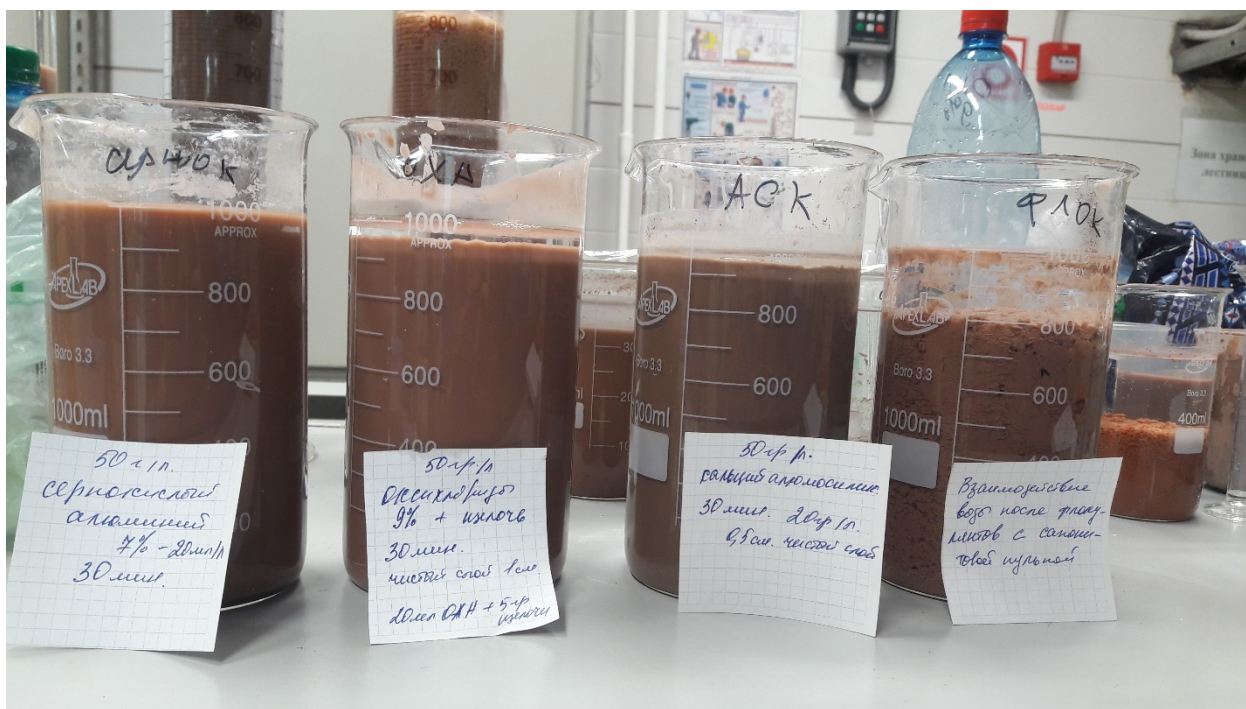
Рисунок 4.10 Результаты по осаждению сапонитовой пульпы, содержание твердого 50-60 г/л спустя 30 минут (стакан 1,2,3)
