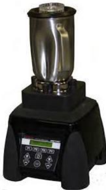
Рисунок 6 – Миксер постоянной скорости Chandler Engineering (модель 3260)
