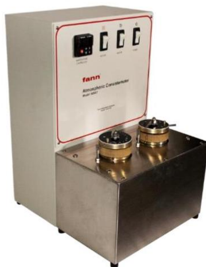
Рисунок 14 – Атмосферный консистометр модель 165АТ
