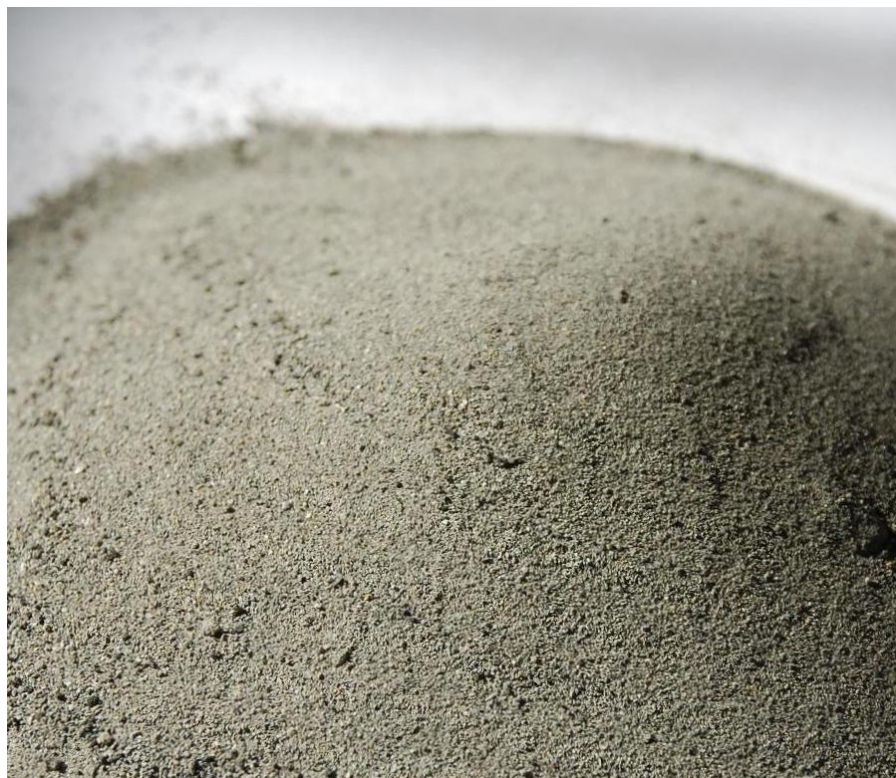
Рисунок 5 – Высококальциевая зола уноса ТЭЦ
