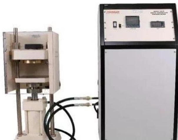
Рисунок 13 – Прибор для испытания предела прочности при сжатии Chandler Engineering Модель 4207D
