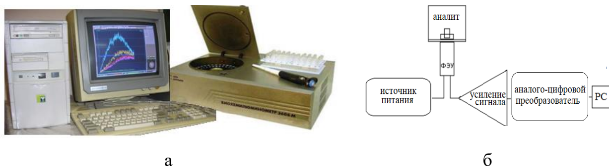
Рис. 2.2. Общий вид (а) и схема (б) автоматизированного комплекса для хемилюминесцентного анализа
