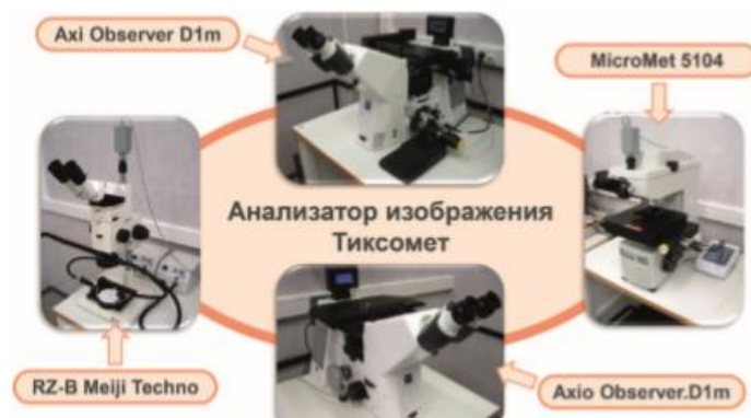
Рисунок 1 - Схема интеграции оптических микроскопов и микротвердомера в единую систему анализа изображений
