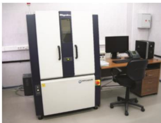
Рисунок 6 - Многофункциональный рентгеновский дифрактометр Ultima IV
