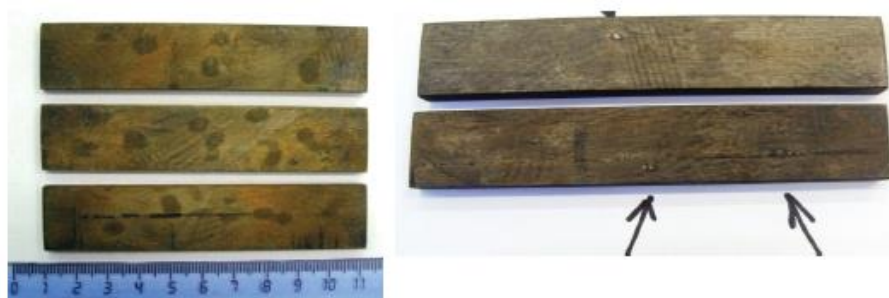
Рисунок 19 - Внешний вид вздутий на поверхности образцов после коррозионных испытаний
