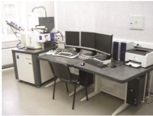
Рисунок 7 - Автоэмиссионный растровый электронный микроскоп Ultra 55
