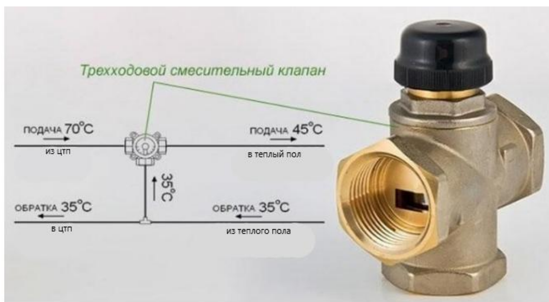
Рис. 3.4. Принцип работы трех ходового смесительного клапана
