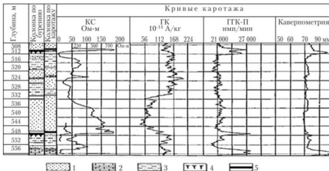
Рис. 2. Геофизические исследования (каротажные диаграммы) в разведочных скважинах: 1 — песчаники; 2 — известняки; 3 — алевролиты и аргиллиты; 4 — углистые породы; 5 — каменный уголь. Источник - А.Г. Милютин. Геология. // https://studme.org
