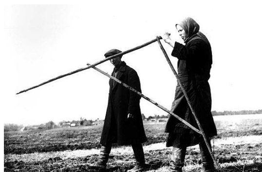
Рисунок 2.14 – Использование в землемерных работах идеи пропорционального циркуля Г. Галилея
