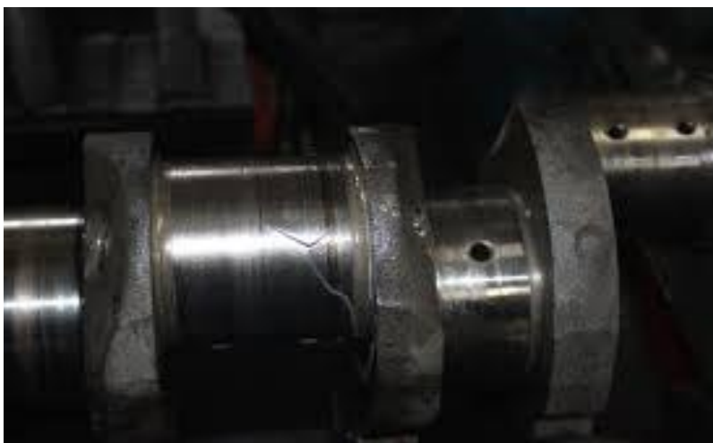
Рисунок 33 – Трещина на шейке коленчатого вала
