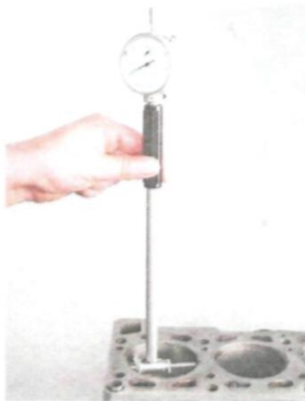
Рисунок 34 – Измерение цилиндра нутромером с индикатором часового типа
