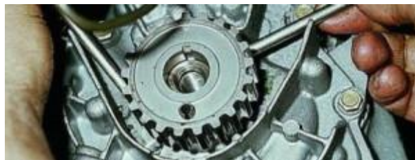
Рисунок 21 – Демонтаж шестерни ГРМ
