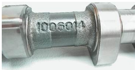
Рисунок 15 – Место нанесения маркировки распределительных валов
