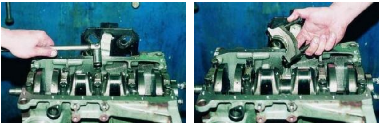
Рисунок 26 – Демонтаж крышек крепления коренных подшипников
