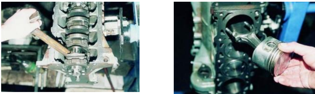
Рисунок 25 – Демонтаж поршня с шатуном
