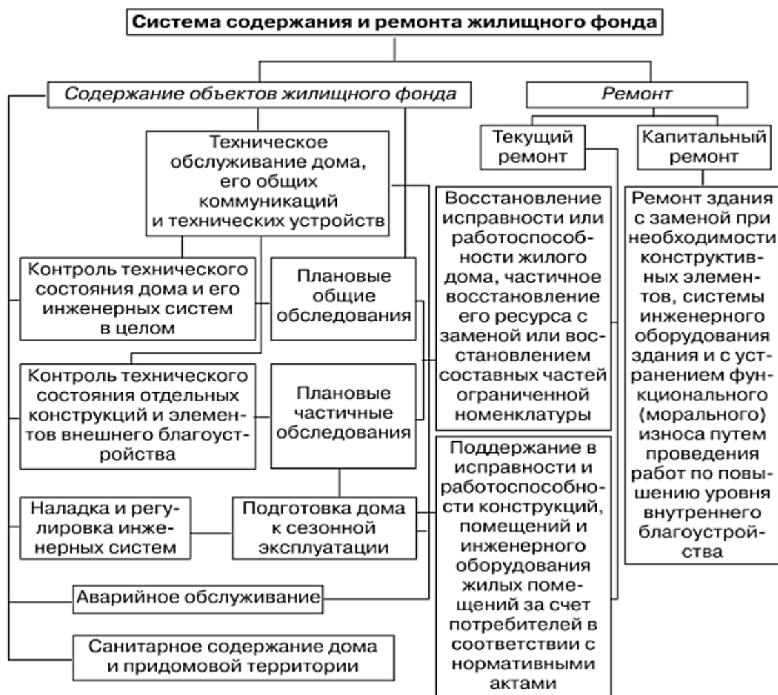
Рис. 8. Схема содержания и ремонта жилищного фонда
