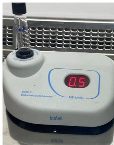
Рис. 37. Приготовление суспензий.      Рис. 38. Мутность суспензий смотрели на денситометре.
