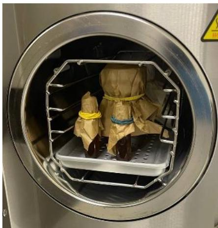
Рис.22. Автоклавирование образцов экстрактов.
