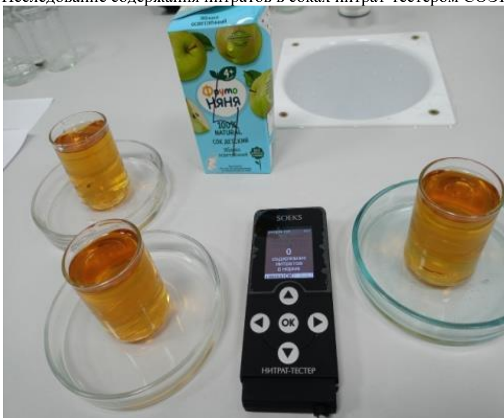
Фото 4. Исследование содержания нитратов в соках нитрат-тестером СОЭКС 2
