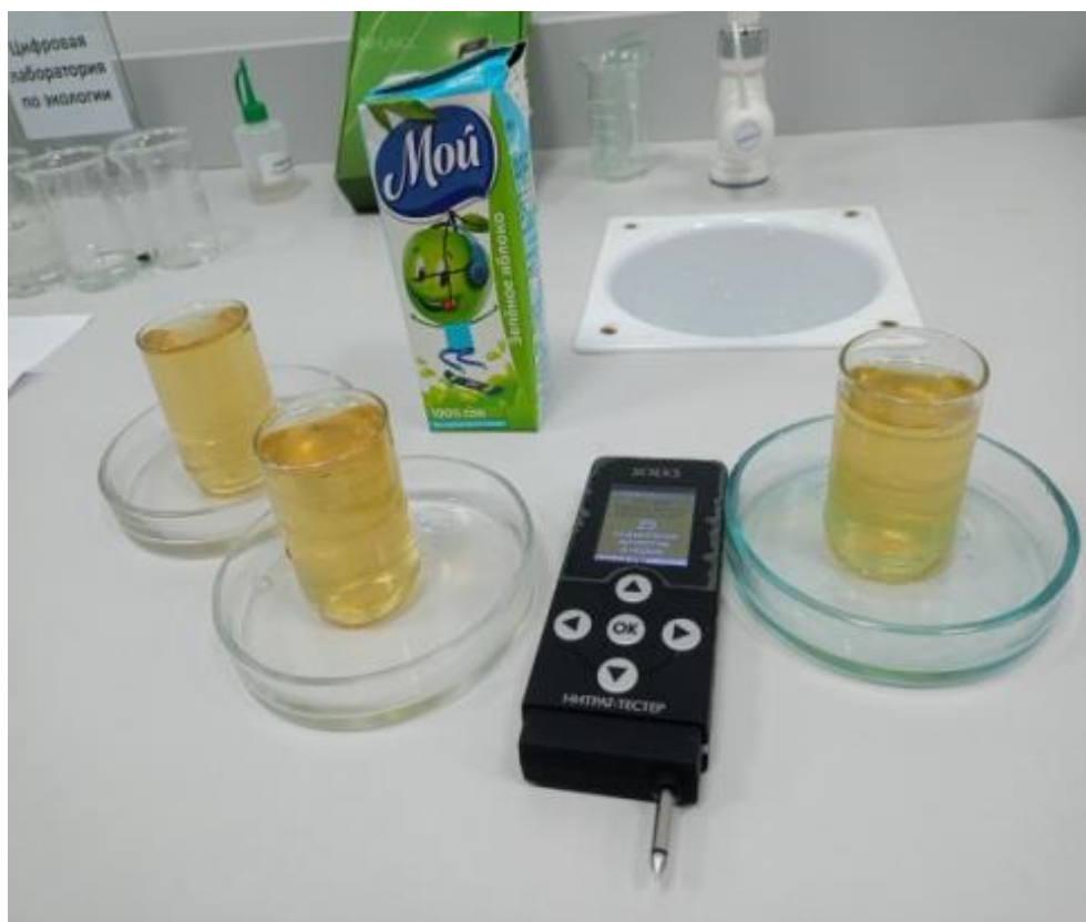
Фото 4. Исследование содержания нитратов в соках нитрат-тестером СОЭКС 2
