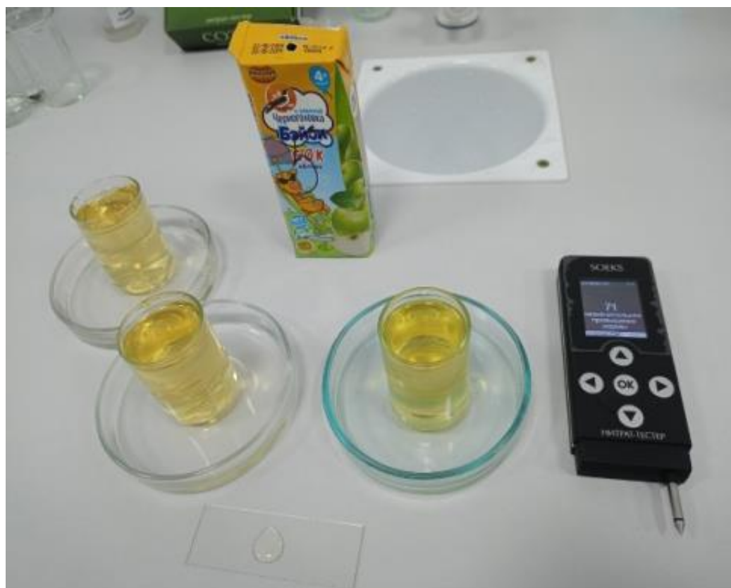
Фото 2. Исследование содержания нитратов в соках нитрат-тестером СОЭКС 2
