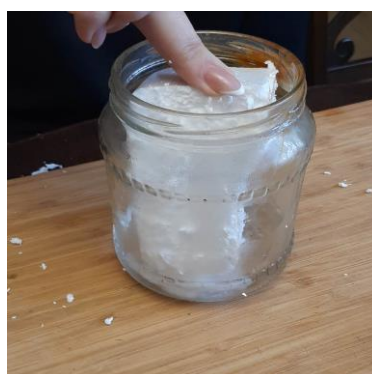
Рисунок 3 Заливка пластика растворителем
