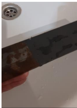
Рисунок 8 влагостойкие свойства нанесенного покрытия
