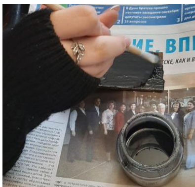
Рисунок 6 Процесс нанесения жидкого пластика на металл
