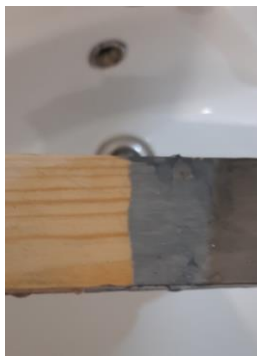
Рисунок 8 влагостойкие свойства нанесенного покрытия
