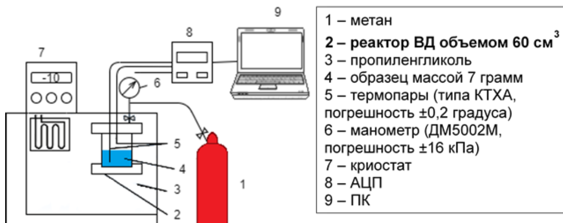
Рис. 4. Схема лабораторной установки гидратообразования ПГ
